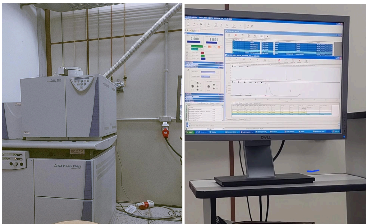
Fig. 5. Flash HT Plus, 5 Advantage, Thermo Scientific, Alemanha, foi utilizado para análises de espectrometria de razões isotópicas (IRMS) de C e N. Acervo pessoal autor, 2024.
